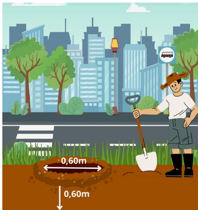
Figura 107: Dimensões adequadas da cova/berço para as mudas da arborização de ruas.
