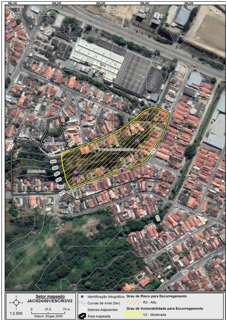
**GRAU DE RISCO: R 3 – RISCO ALTO PARA DESLIZAMENTO**
