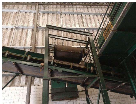
Figura 44 UTMB –triagem magnética (15/09/2021).
