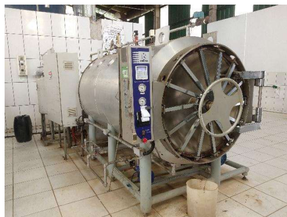
Figura 99 Autoclave utilizada no tratamento (15/09/2021).
