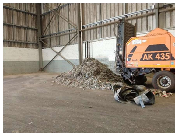
Figura 52 UTMB – equipamento utilizado para triturar os rejeitos (15/09/2021).
