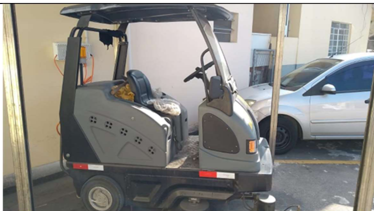
Figura 72 Equipamento utilizado para varrição mecânica (09/2021).
