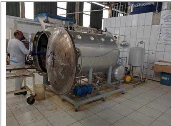
***Figura 100 Operação da autoclave
