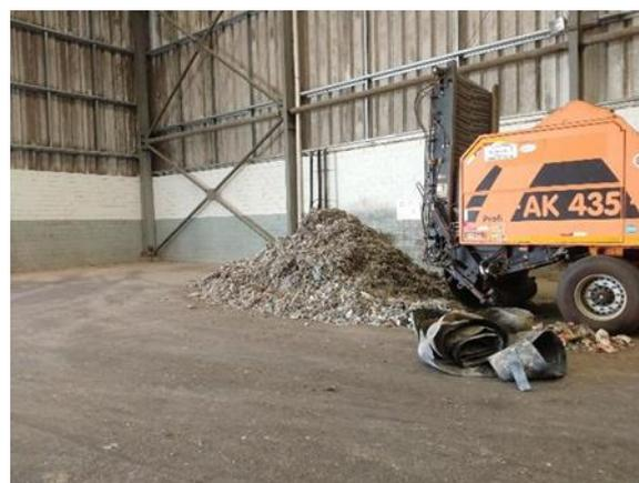
**Figura 52 UTMB – equipamento utilizado para triturar os rejeitos (15/09/2021).**
