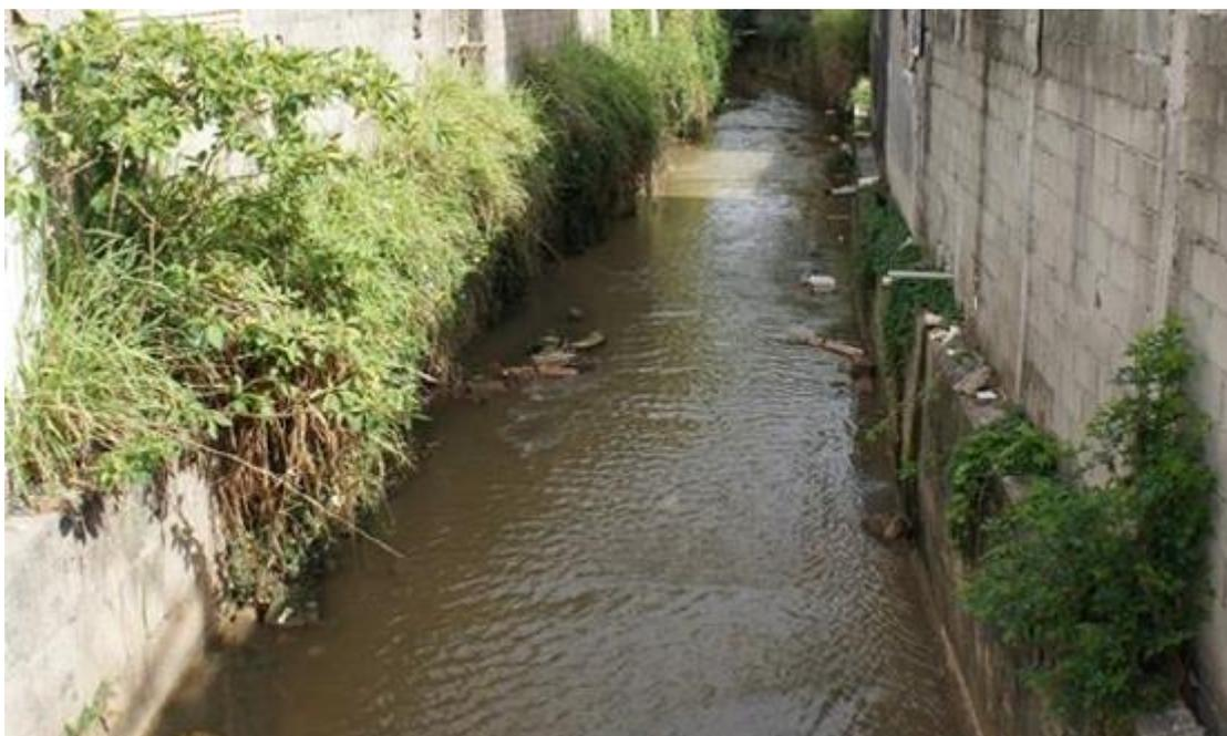
***Figura 15 - Trecho em que o Rio Turi corre confinado entre muros de divisa de terrenos, sem acesso para manutenção***
