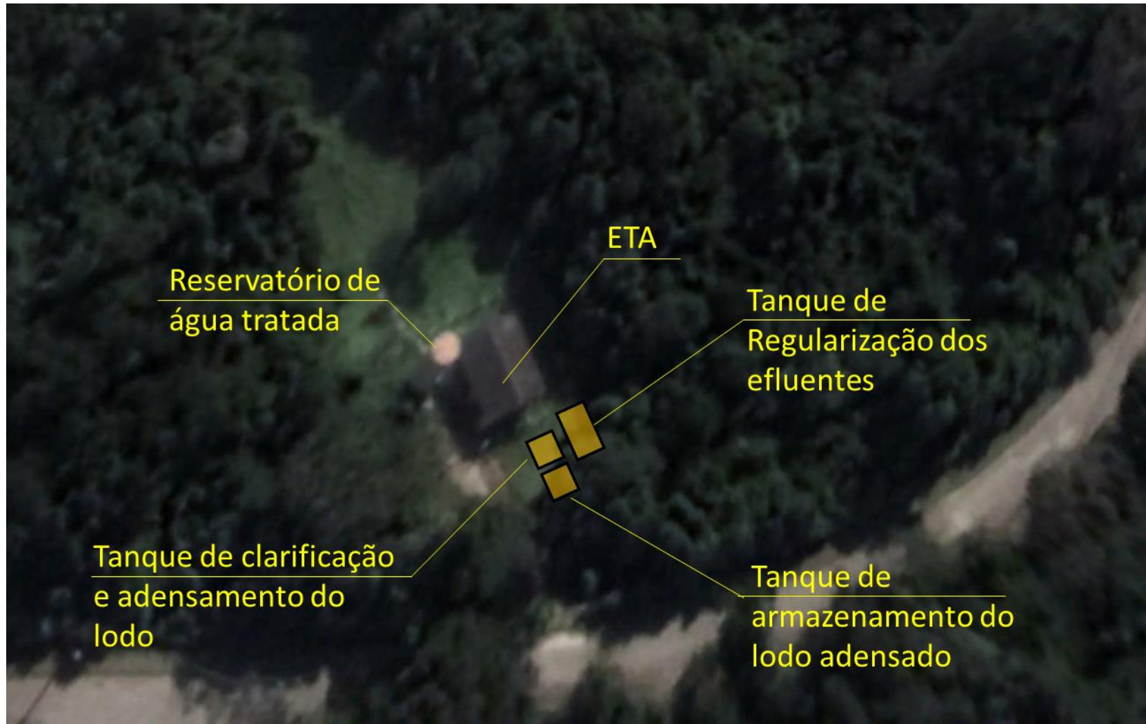
Figura 17 ETA III Lay-out preliminar de implantação do sistema de tratamento dos efluentes
