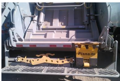
Foto 29 – Caminhão com guindaste para coleta de contêineres de 240 litros
