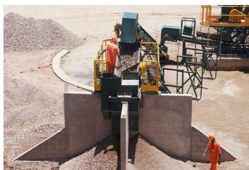
Foto 66 – Triturador de resíduos inertes em funcionamento
